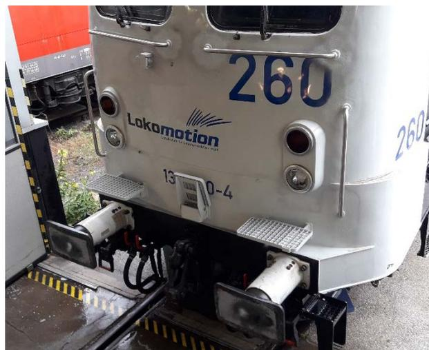
Situation mit hochgeklappten mittleren Tritt
